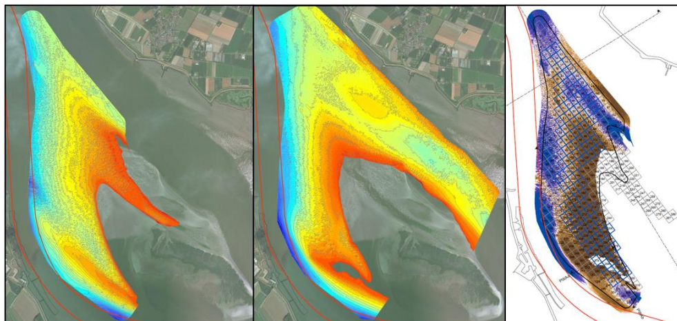
Figuur 6-36: Bathymetrie van plaatrandstortvak Plaat van Walsoorden in februari 2010 (links) en februari 2020 (midden) en de verschilkaart (rechts). Blauwe rechthoekjes zijn de ingezette stortvakken.
